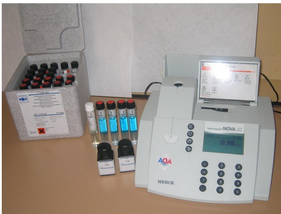
Obr.10: Sada pro stanovení aniontových tenzidů a spektrofotometr Spectroquant NOVA 60
