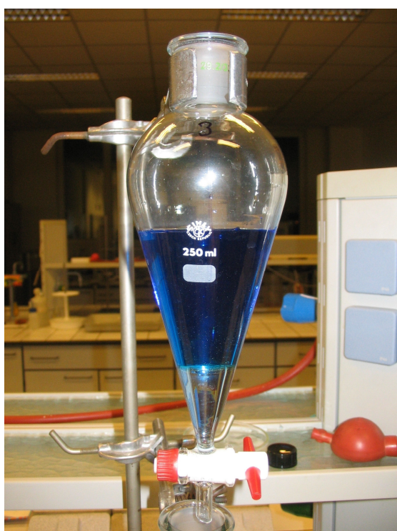
Obr.12: Dělící nálevka se vzorkem odpadní vody po přidání reakčních činidel.
