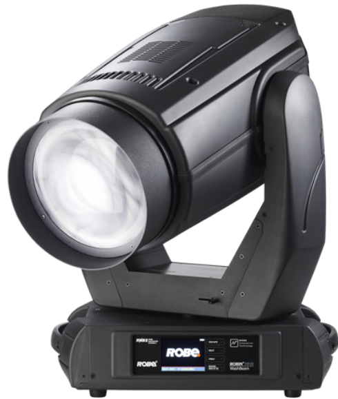
Obrázek 2.9: Beam svítidlo. Od zařízení typu Spot jej lze na první pohled odlišit díky použití Fresnelovy čočky v předním členu optiky. Převzato z [42]
