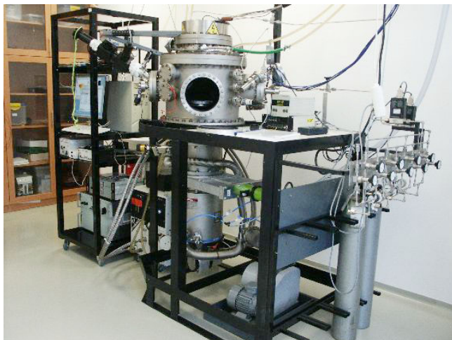
(a) Depoziční aparatura Kaufman v laboratoři ÚFI. (b) Držák na vlákna pro depozici v aparatuře Kaufman.
