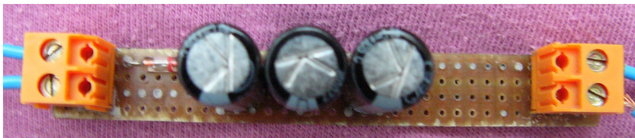
Obr. 30: Vyrobený jednocestný usměrňovač s filtračními kondenzátory
