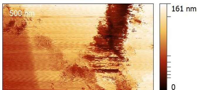
Obrázek 6.8: Měření vzorku HOPG STM v softwaru GXSM. Parametry měření: V_{Bias} = 0,1 \text{ V} , I_s = 2,5 \text{ nA} .
