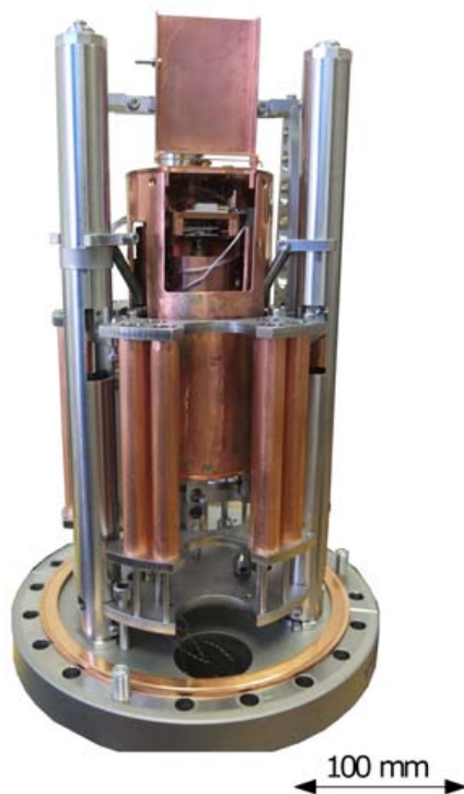
Obrázek 5.3: Sestavený nízkoteplotní UHV STM.
