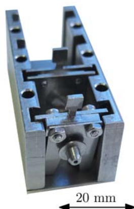
Obrázek 4.11: Model vyrobeného zásobníku s vloženými paletkami se vzorkem a držákem hrotu.
