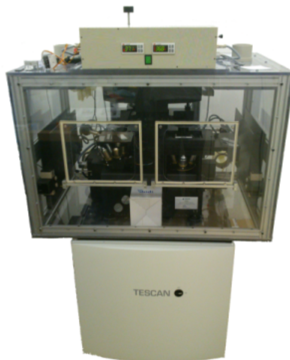
Obrázek 2: Koherencí řízený holografický mikroskop 2. generace je umístěn ve vyhřívaném průhledném boxu.
