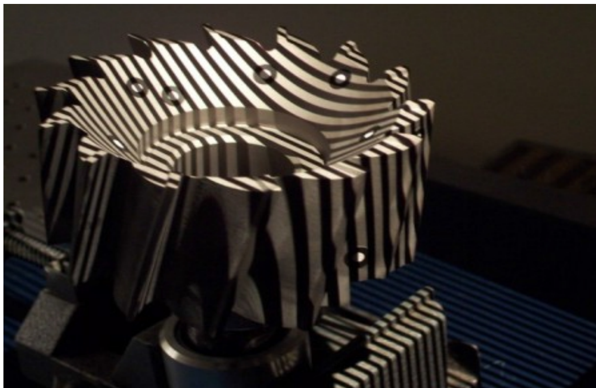
Obr. 17 Navigace 3D skeneru pomocí orientačních značek [18]
