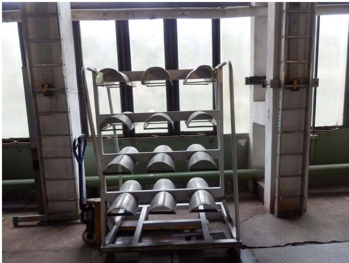
Obr. 26 Silně deformovaný pintrack.
