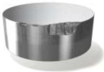
Obr. 14 Odlupování části nástroje [16]
