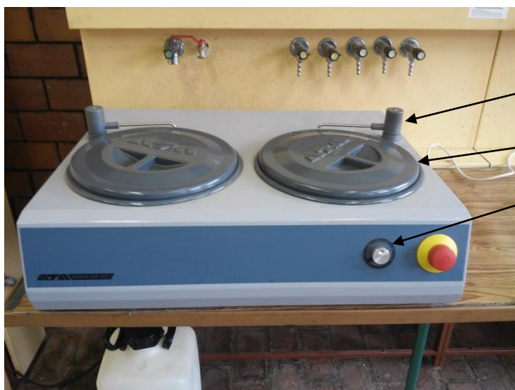
1 – přívod vody, 2 – brusný disk, 3 – regulátor otáček Obr. 57 Dvoukotoučová bruska Saphir 330
