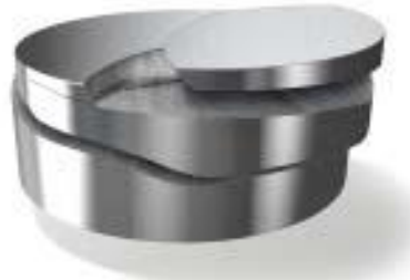
Obr. 15 Pokročilé stádium vyštipování nástroje [16]
