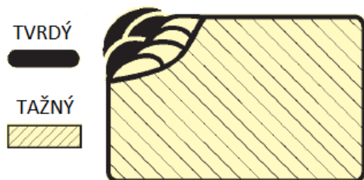
Obr. 34 Struktura návarů s mezivrstvou [12]
