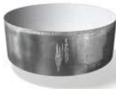
Obr. 9 Adhezivně opotřebený nástroj [16]
