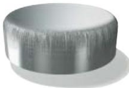
Obr. 5 Opotřebení hrany nástroje [16]
