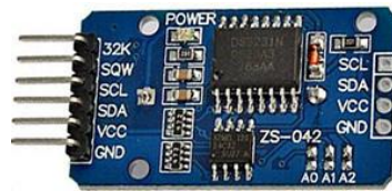
Obr. 8 Modul reálneho času s čipom DS3231
