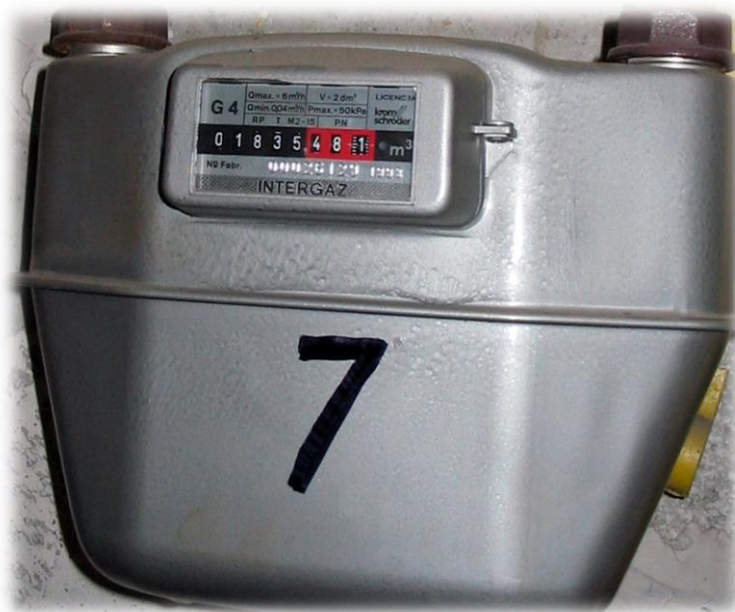
Obr. 1.1: Zástupce membránového plynoměru pro domácnosti [1]
