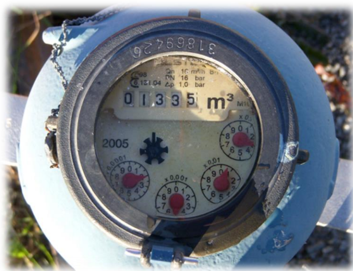
Obr. 1.3: Zástupce lopatkového vodoměru pro domácnosti [3]
