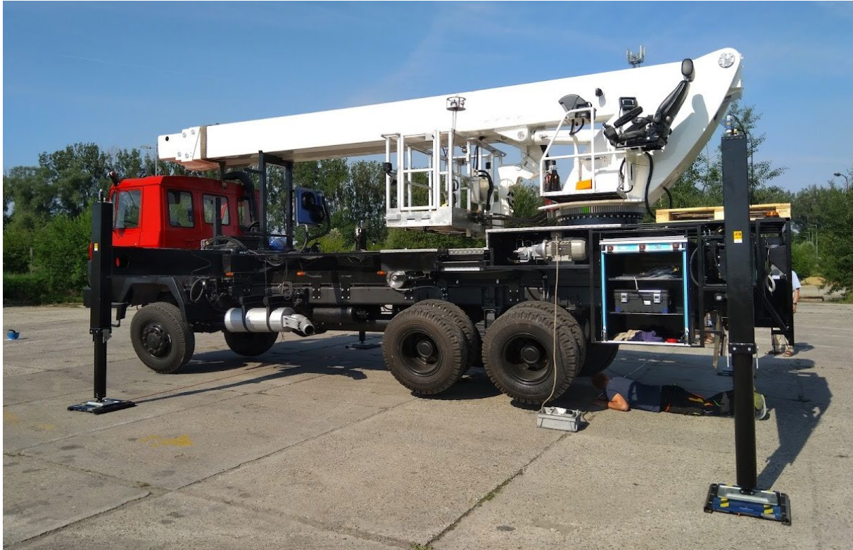
Montážní plošina AP30 v areálu Slováckých strojířen, a.s. v Uherském Brodě, zkoušky stability.
