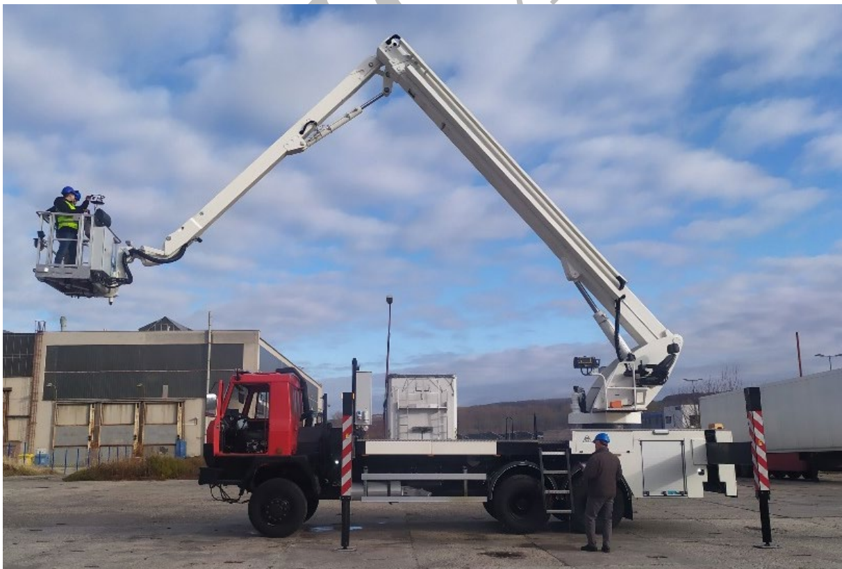
Montážní plošina AP30 v areálu Slováckých strojířen, a.s. v Uherském Brodě, prototypové zkoušky.
