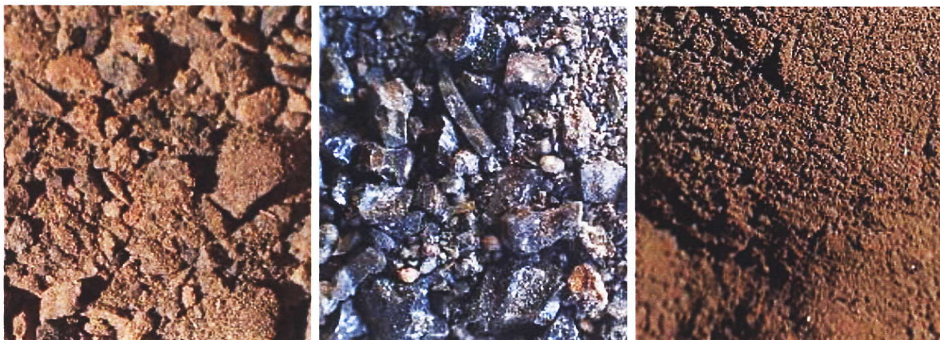
Obr. 1: Netradiční suroviny, jako substituční složky pojiva a matrice - agloporit (vlevo), škvára (v surovém stavu - uprostřed) a škvára jemně mletá (vpravo).
