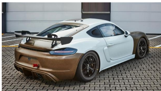
Obr. 1.1 Lněné šasi závodního Porsche Cayman [6]
