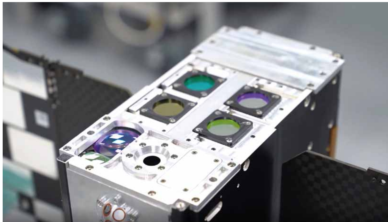
Hyperspektrální kamera ASPECT z CubeSatu HERAMilani
