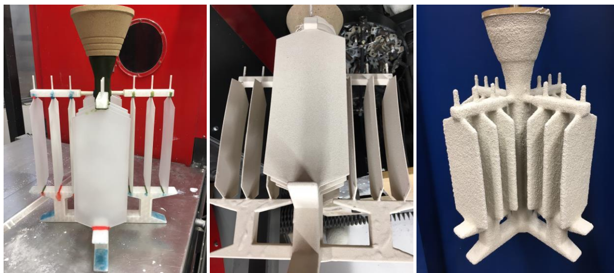
Obr. 5.47 Příprava modelu a výroba testovací skořepiny
