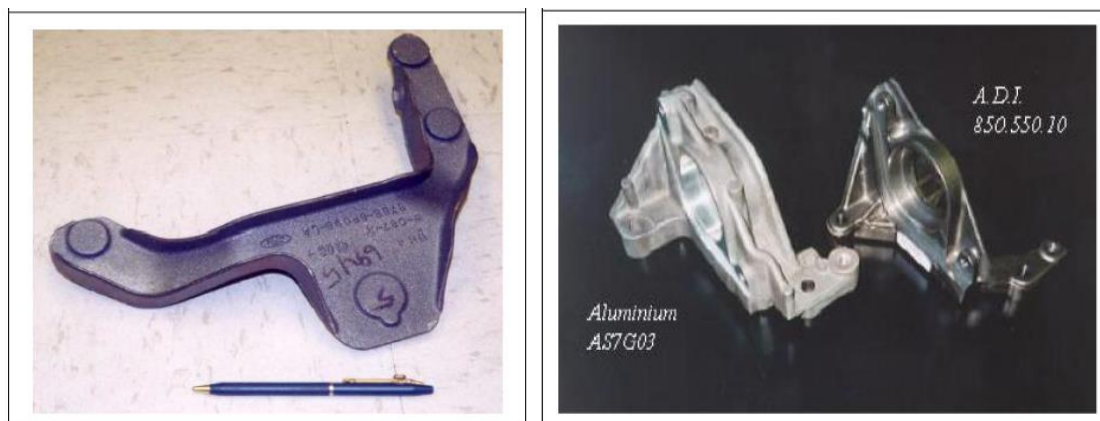
Obr. 2.5 Odlitek prototypu konzoly o tloušťce 3 mm (vlevo) a náhrady Al konzoly odlitkem z ADI litiny [15]
