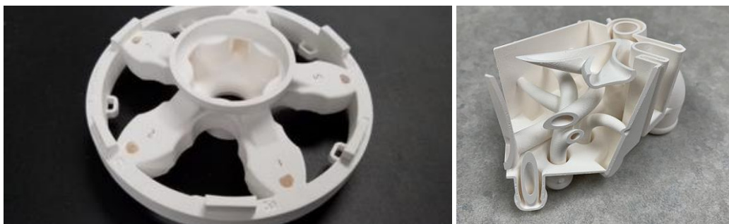
Obr. 3.10 3D tisk keramické skořepiny [55]
