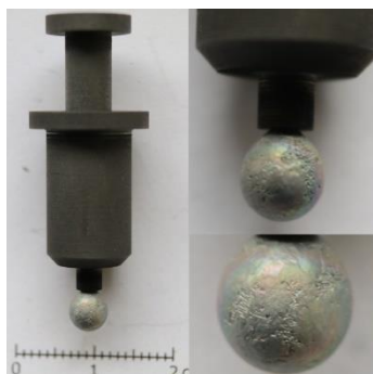
Obr. 5.40 Ztuhlá slitina po ukončení testu
