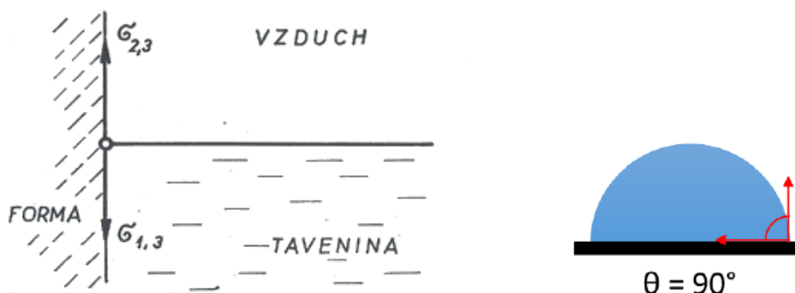
Obr. 5.24 Indiferentní stav povrchu [120]
