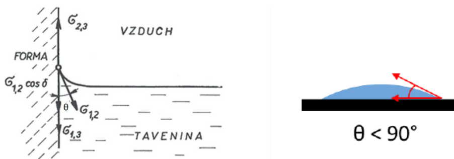
Obr. 5.25 Metalofilní stav povrchu [120]
