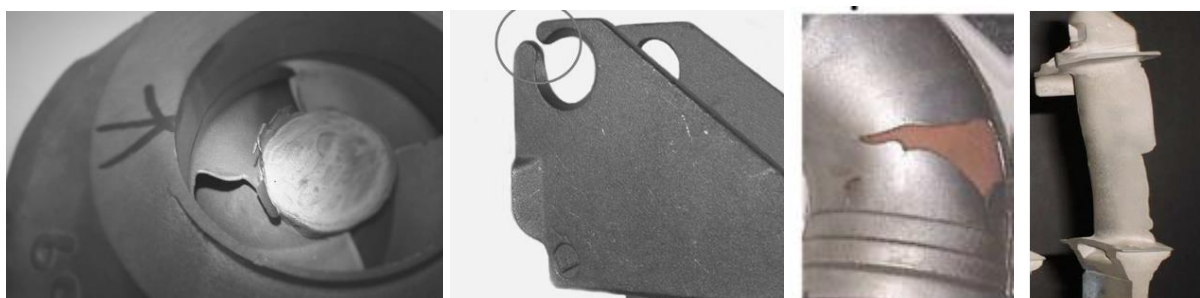
Obr. 5.2 Vady odlitku spojené se zabíhavostí taveniny [69], [70], [71]
