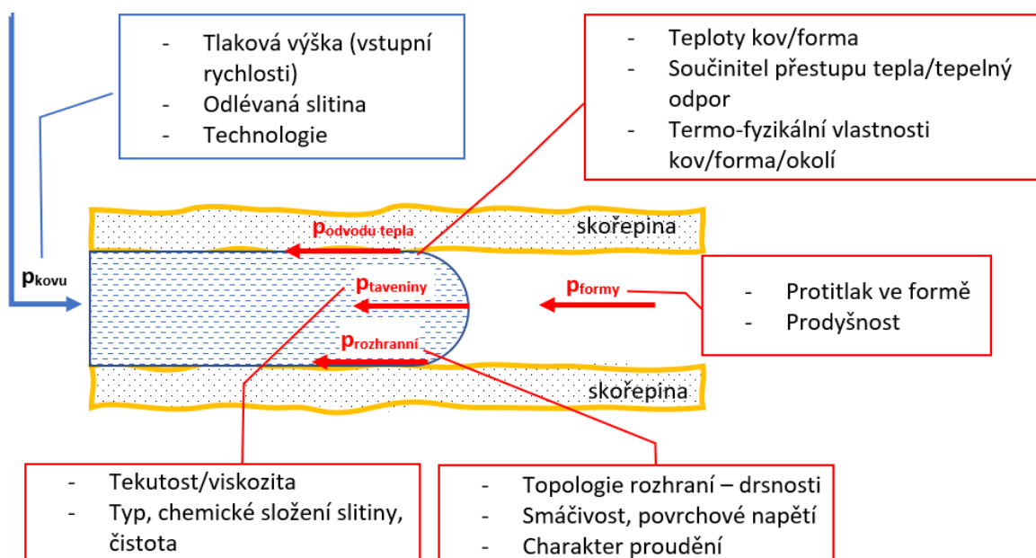
Obr. 5.1 Schematické znázornění silového působení při proudění taveniny v keramické formě
