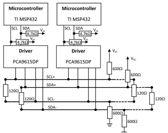
Fig. 6. dI<sup>2</sup>C circuit.
