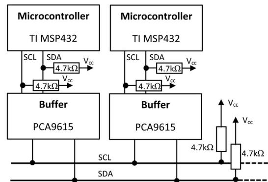
Fig. 5. I<sup>2</sup>C circuit.
