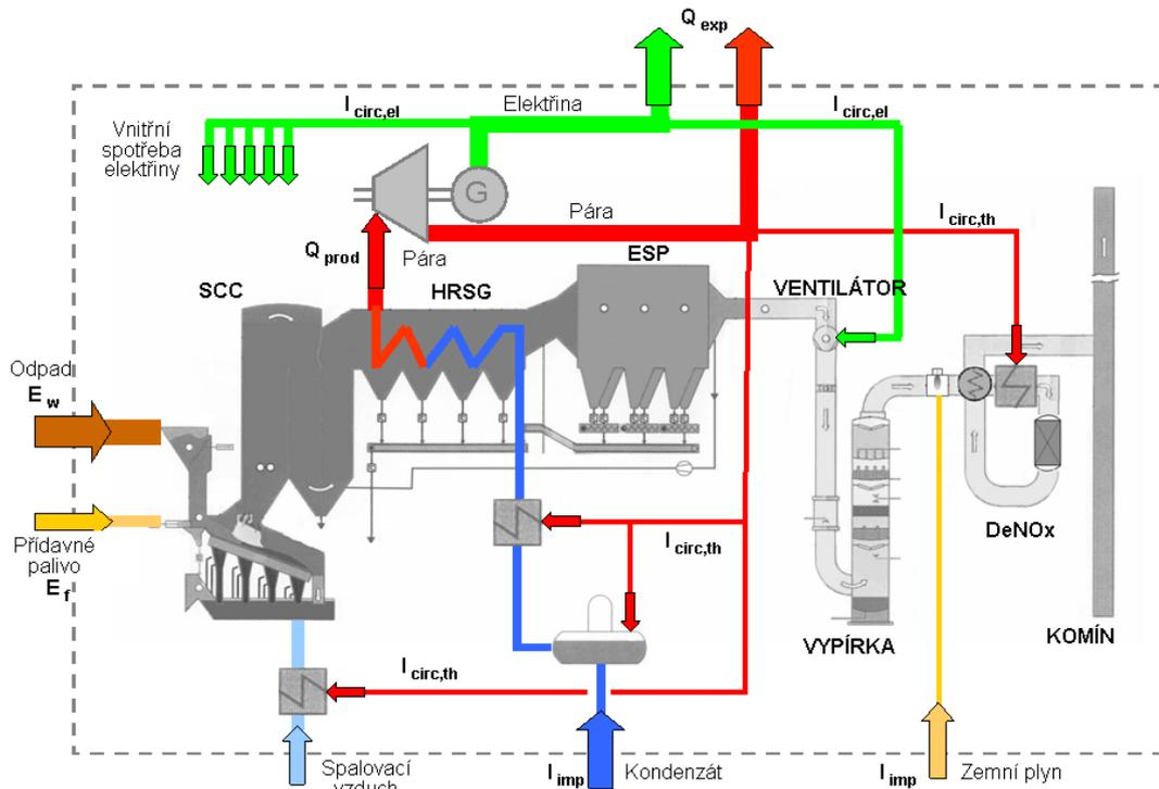
Obr. 6 Hlavní toky energie roštové oxidační spalovny s využitím energie [A5]
