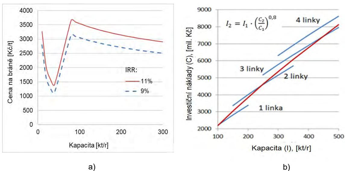
Obr. 9 Výpočet ceny odpadu na bráně jako výsledek aplikace technicko-ekonomických modelů (a) a použitý model investičních nákladů (b)
