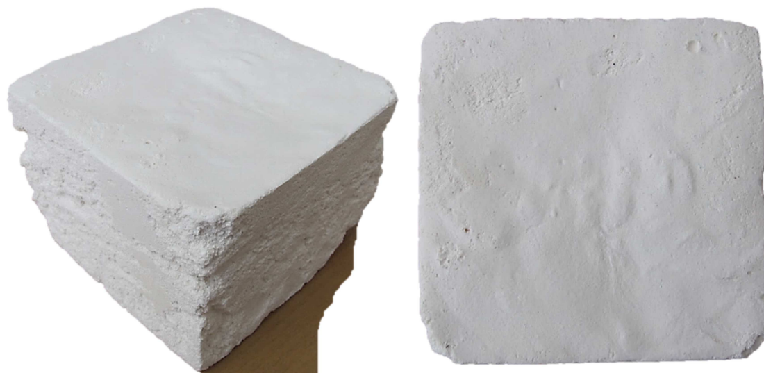
Obr.4.10: Fotografie odlitého a vypáleného bloku keramické pěny na bázi mastku.
