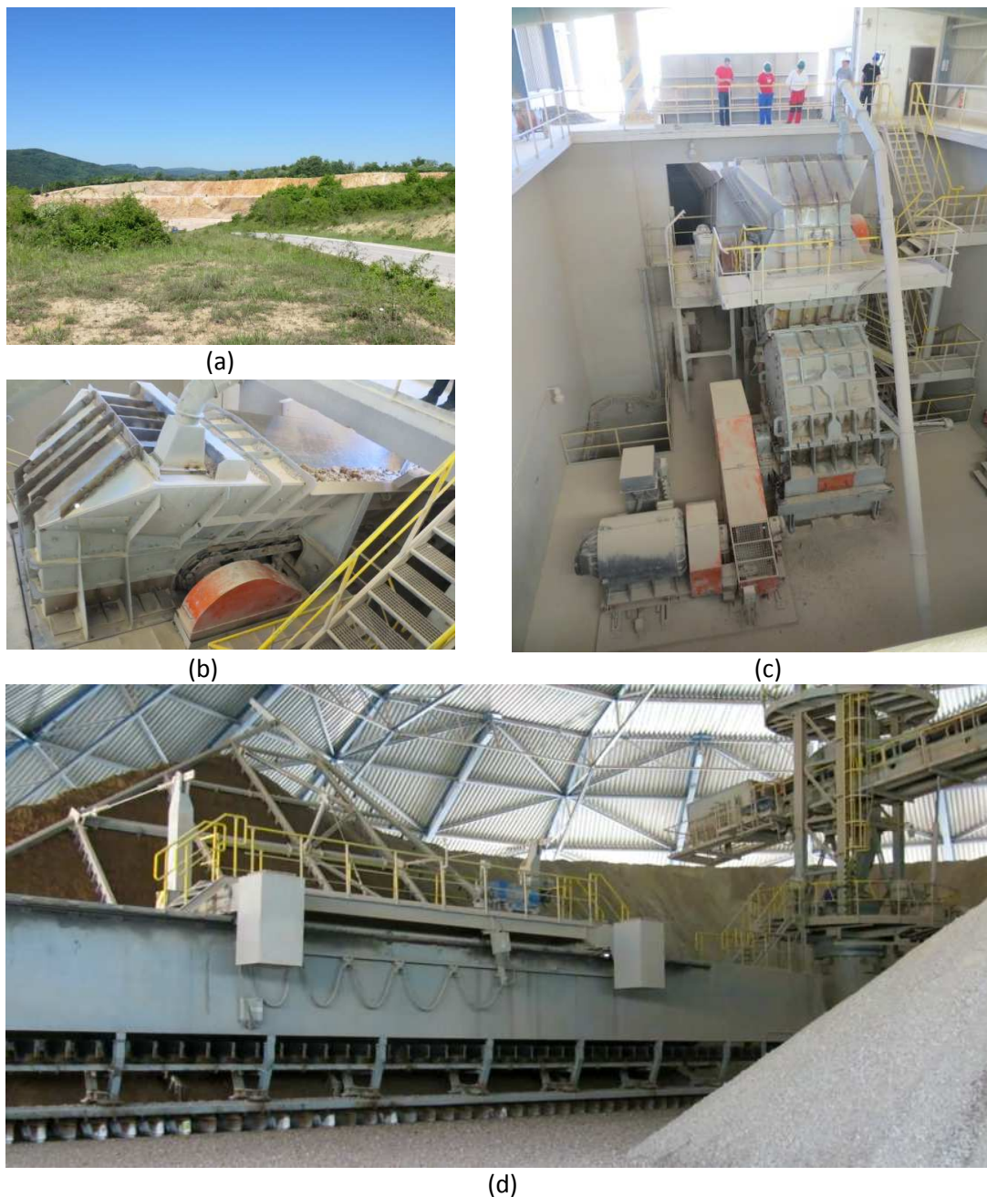
Obr.3.11: Dvouetážový stěnový lom (a), drcení suroviny (b, c) a odběr z homogenačního sila (d). Cementárna Horné Srnie.
