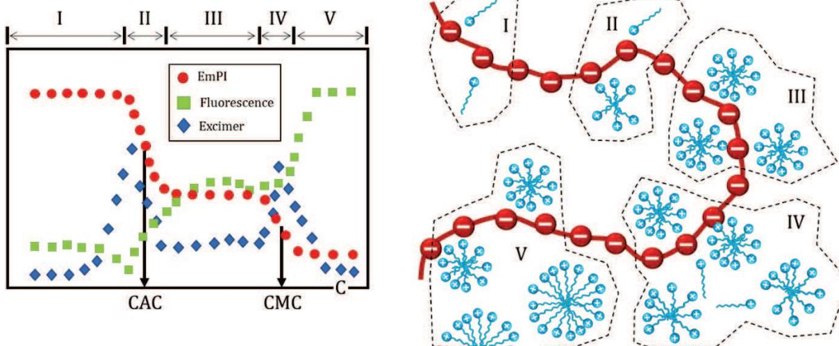
Obrázek 20 Model závislosti pyrenových parametrů emisního polaritního indexu (●), intenzity fluorescence (■) a zastoupení excimeru (◆) v případě konstantního obsahu polyaniontu hyaluronanu (—) a rostoucí koncentrace kationaktivního tensidu (⊕) ve vodném prostředí. Šipky označují začátek indukované agregace (kritickou agregační koncentraci, CAC) a při nasycení řetězce pak kritickou micelární agregaci (CMC). Protionty nejsou zobrazeny.
