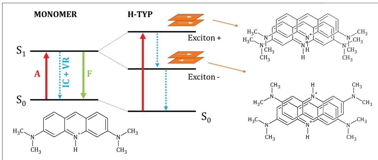
Obrázek 12 Zjednodušený Perrin-Jabłońskiho diagram pro tvorbu excitonových pásů při H-typu agregace Akridinové oranže. Zkratka „A“ značí proces absorpce, „F“ fluorescenci a „IC + VR“ nezářivou deaktivaci procesem vnitřní konverze a vibrační relaxace.
