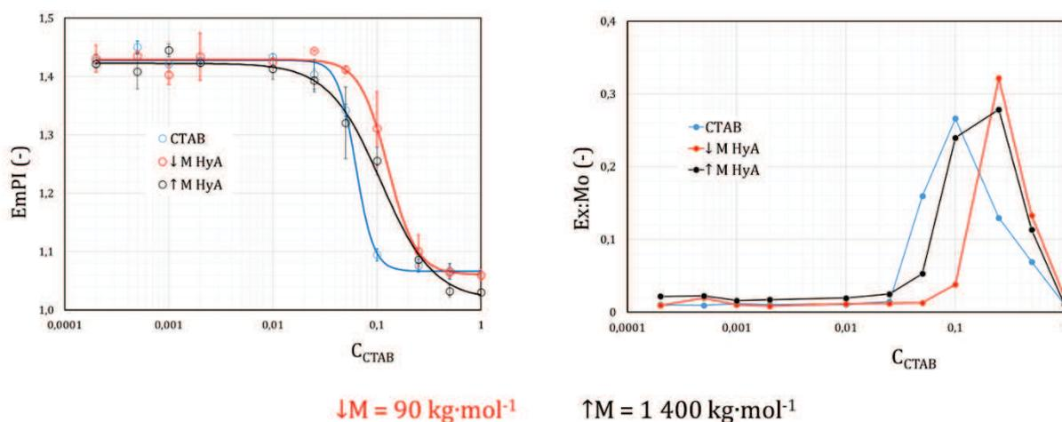
Obrázek 22 Závislost emisního polaritního indexu (adaptováno z [59]) a poměru excimer:monomer (nepublikovaná data) na koncentraci kationaktivního tenzidu ve vodě v přítomnosti hyaluronanu o koncentraci  $1 \text{ g}\cdot\text{L}^{-1}$  a iontové síle  $0,15 \text{ M}$  upravené NaCl.
