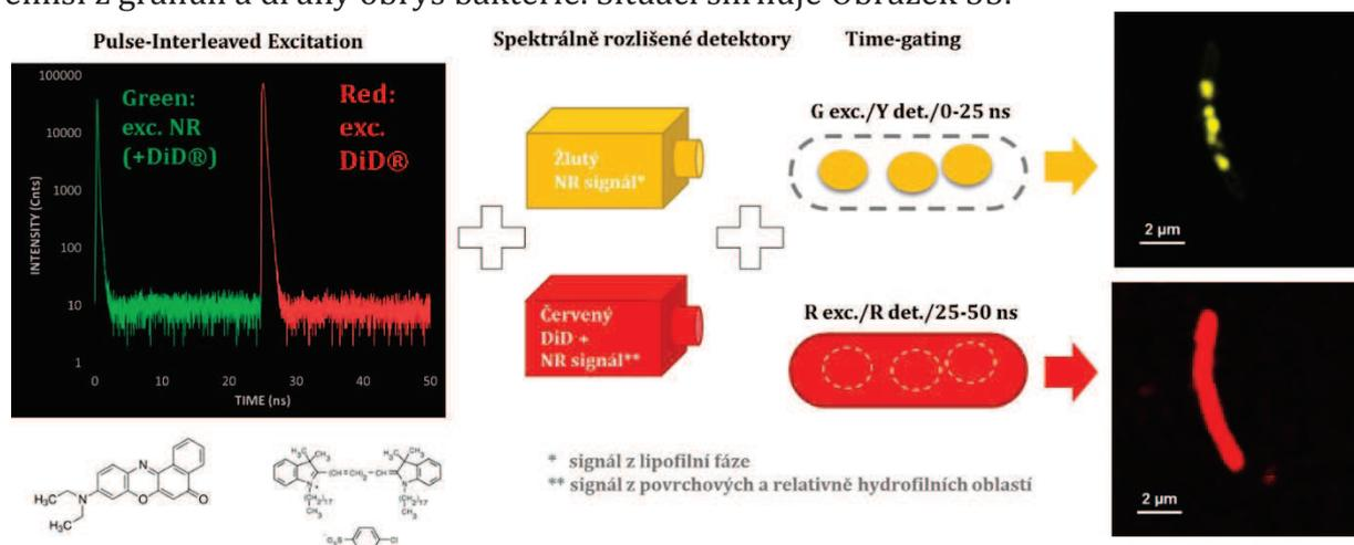
Obrázek 35 Přehled nastavení experimentu pro stanovení zastoupení granulí PHA v bakteriích. Adaptováno dle [69].
