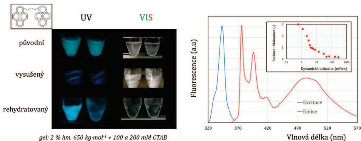
Obrázek 26 Vizualizace vysychání a rehydratace hydrogelu pomocí viskozitní sondy P3P. Na grafu vpravo je excitační a emisní spektrum P3P a ve vloženém grafu nepublikovaná data závislosti poměru intenzity excimeru k intenzitě monomeru na viskozitě. Viskozitní řada byla připravena kombinací methanolu a glycerolu v různých objemových poměrech.
