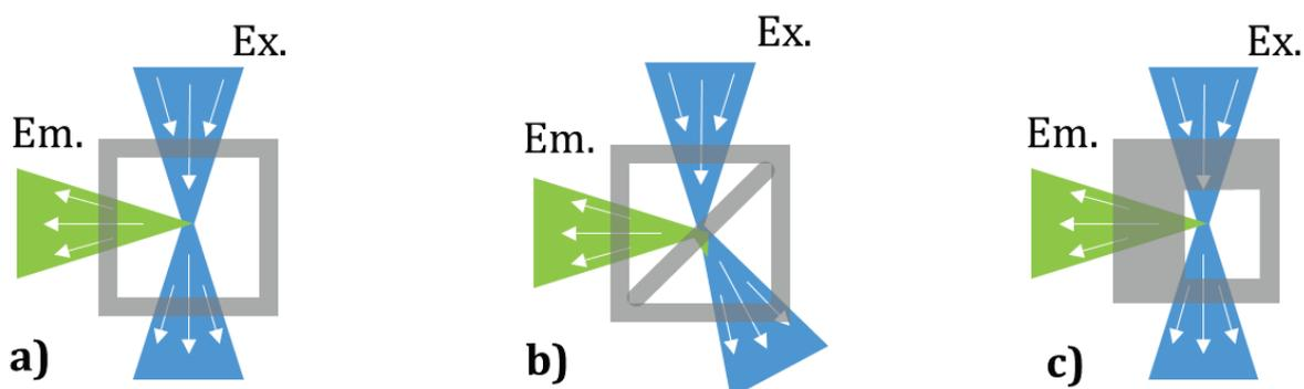
Obrázek 6 Různé způsoby excitace za použití speciálních kyvet. Obrázek schematicky ukazuje, jak lze za použití speciálních kyvet dosáhnout různých způsobů excitace. a) pravouhlá excitace (RA); b) excitace povrchové vrstvy (FF); c) mimostředová excitace (OC).
