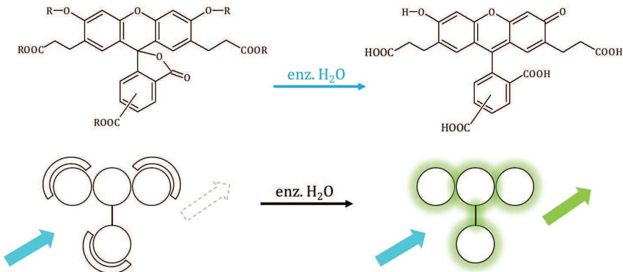
Obrázek 37 Schematické znázornění hydrolýzy izomeru esteru fluorescenční pH sondy BCECF (2',7'-bis-(2-karboxyethyl)-5-karboxyfluorescein).
