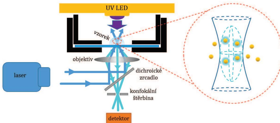
Obrázek 32 Schématická reprezentace uspořádání experimentu pro stanovení temporálních a difúzních parametrů při fotogeneraci kvantových teček. V červeném výřezu je pak tmavě modře naznačený iluminační profil, světle modře konfokální objem a žlutě fluorofory.
