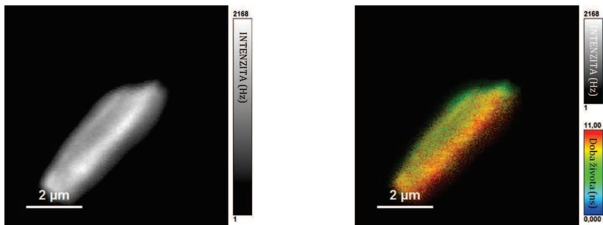
Obrázek 31 Obrázky agregátu nanodiamantů získané pomocí FLIM. Vlevo je obrázek interpretován pouze v intenzitním rozsahu, vpravo pak v kombinaci s rozsahem dob života.
