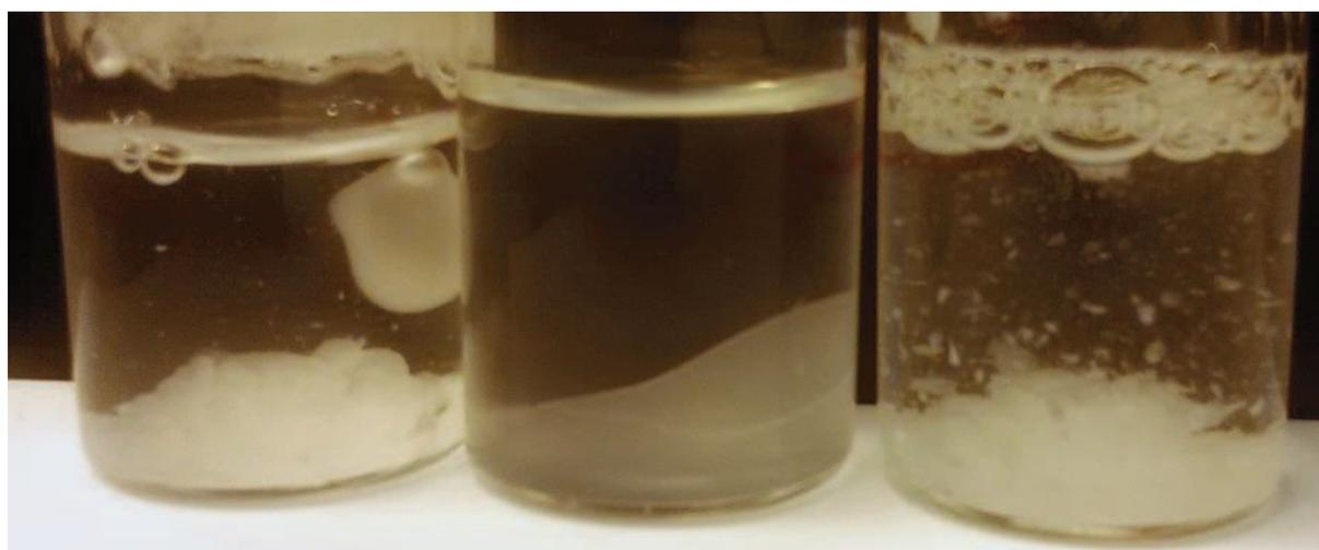
Obrázek 23 Fázově separovaný hydrogel z tenzidu CTAB a hyaluronanu. Mléčné zakalení je způsobeno intenzivním protřepáním na vortexu před odstředěním. Tato opalizace vymizí do 48 h při nerušením stání za laboratorních podmínek. Různé formy hydrogelu před ustálením ukazují vliv molekulové hmotnosti – zleva doprava vysoká (~1 500 kDa), střední (~500 kDa) a nízká (~80 kDa).
