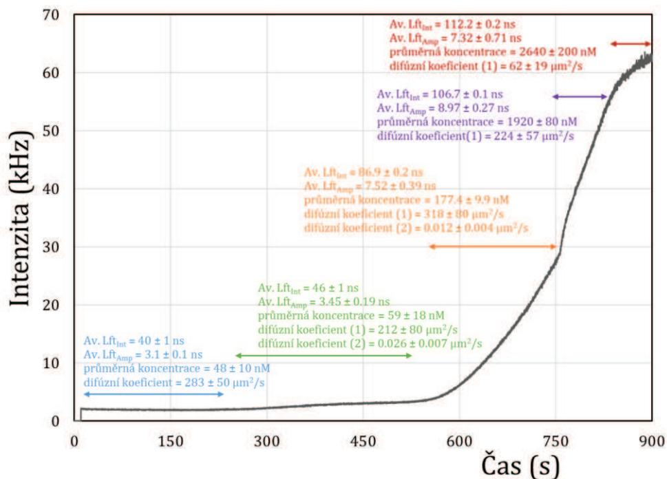
Obrázek 33 Průběh nárůstu intenzity fluorescence v čase při iluminaci prekursorů Cd:Se. Šipky naznačují oblasti s obdobným chováním (posuzováno podle chyb stanovení jednotlivých parametrů). U jednotlivých oblastí jsou zaznamenány parametry doby života zprůměrované přes intenzitu (Av.  $Lft_{Int}$ ), doby života zprůměrované přes amplitudu (Av.  $Lft_{Amp}$ ), průměrnou koncentraci a difúzní koeficient( $\gamma$ ).
