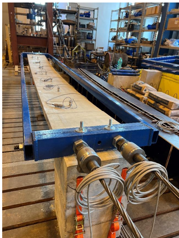
Obr. 6.14 Fyzikální model s osazenými akcelerometry a siloměry
