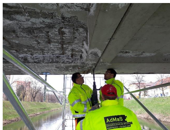
Obr. 4.8 Vrtané sondy prováděné zespod z prohlížecké plošiny
