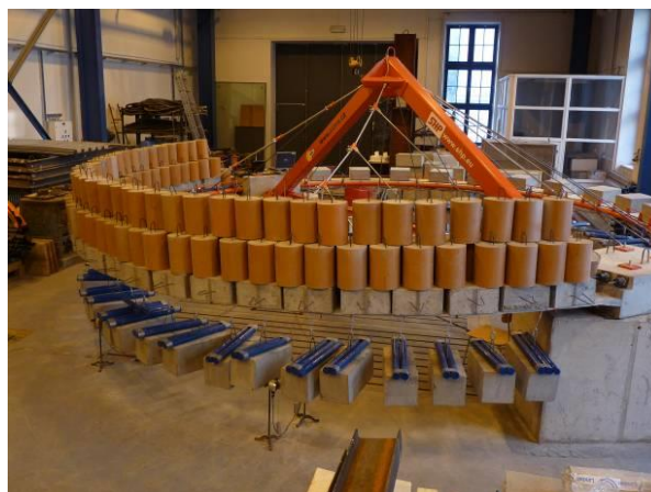
Obr. 3.69 Mezní zatěžovací zkouška visuté části modelu
